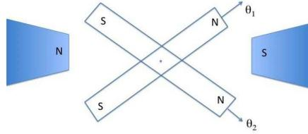
Les deux aimants sont placés dans l'entrefer d'un électroaimant. Soit  $\theta_1$  et  $\theta_2$  les deux angles repérant les pôles nord des aimants par rapport à l'axe horizontal (sens trigonométrique). La dynamique des deux aimants est donnée par le système d'équations, ayant  $K > 0$  :
