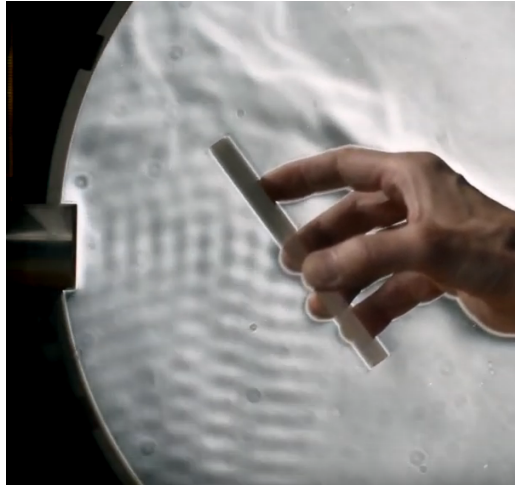
FIGURE 3.1 – Ondes sonores (ultra sons) observées par effet Schlieren et par éclairage stroboscopique. Les ondes sont émises à gauche et se réfléchissent sur la plaque. On observe des figures d'interférence.
