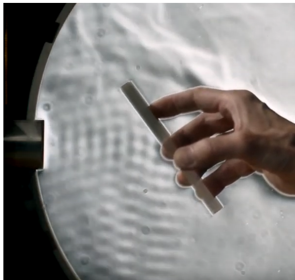
FIGURE 1.2.1 – Ondes sonores (ultra sons) observées par effet Schlieren et par éclairage stroboscopique. Les ondes sont émises à gauche et se réfléchissent sur la plaque. On observe des figures d'interférence.
