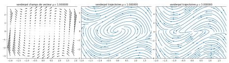
On observe que toutes les trajectoires sont attirés vers une trajectoire périodique, appelée cycle limite, qui se déforme si  $\mu$  augmente. Plus tard on verra que sa période  $T_{\tau}$  augmente avec  $\mu$ , et  $T_{\mu} \to 2\pi$ . Pour avoir un effet sonore intéressant, on décide de fixer le paramètre  $\mu$  à la vélocité v de la  $v \to 0$
