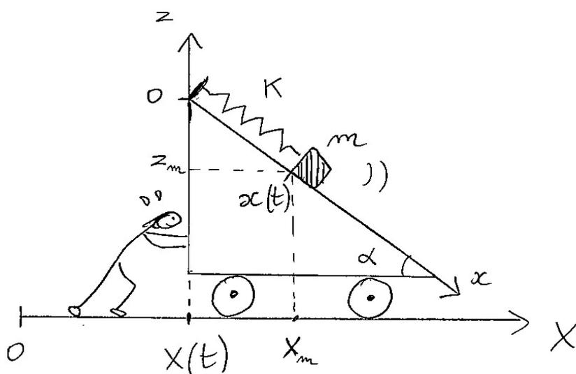
1. (★) (3) Ecrire le Lagrangien  $L(x, V_x)$  de la masse  $m$ , où  $V_x = \frac{dx}{dt}$ . (Aide : au passage utiliser les variables  $X_m, z_m$  indiquées sur la figure).
