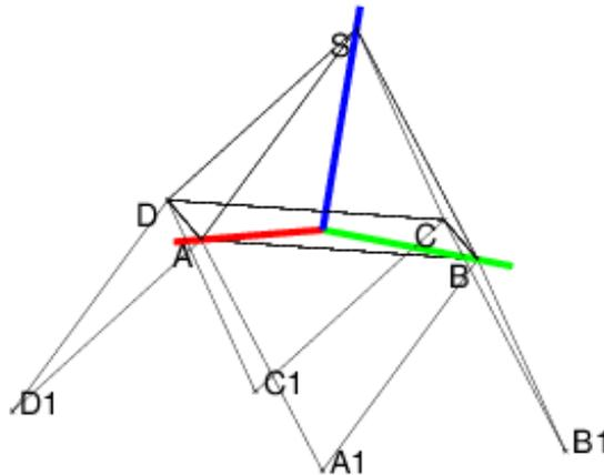
Elle est constituée par les 4 losanges  $SAA_1B_1$ ,  $SBB_1C_1$ ,  $SCC_1D_1$ ,  $SDD_1A_1$  où  $SABCD$  est une pyramide de hauteur  $h$  et de base carrée  $ABCD$  ( $(AC/2)^2 = l^2 - h^2$  et  $AB = AC/\sqrt{2}$ ) et où  $A_1$  est le symétrique de  $S$  par rapport au milieu de  $AB$ ,  $B_1$  est le symétrique de  $S$  par rapport au milieu de  $BC$  etc...
