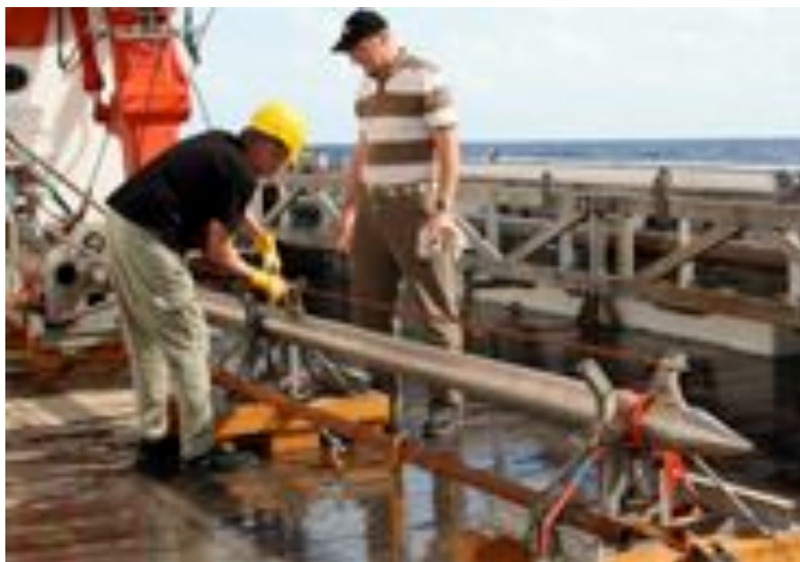
Figure 3.2 – Instrument utilisés pour mesurer le flux de chaleur provenant de l'intérieur de la Terre dans les sédiments océaniques
