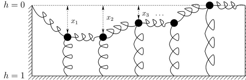
On note  $x_1, \dots, x_n$  les écarts entre les nœuds et l'horizontale. L'énergie du système est la somme des énergies de chaque ressort. En supposant chaque  $x_i$  assez petit et en prenant toutes les constantes égales à 1, l'énergie du système est donc donnée par
