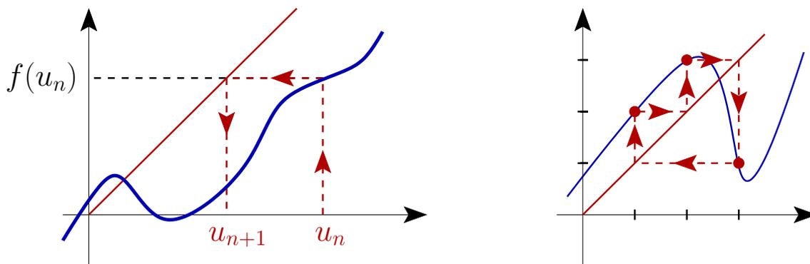
FIGURE 2.4 – À gauche, une construction graphique du point  $u_{n+1} = f(u_n)$  qui utilise la droite d'équation  $y = x$  permettant de renvoyer l'ordonnée  $y = f(u_n)$  sur l'abscisse  $u_{n+1} = f(u_n)$ . À droite, un exemple de fonction admettant le cycle  $1 \rightarrow 2 \rightarrow 3 \rightarrow 1$  pour la récurrence  $u_{n+1} = f(u_n)$ .
