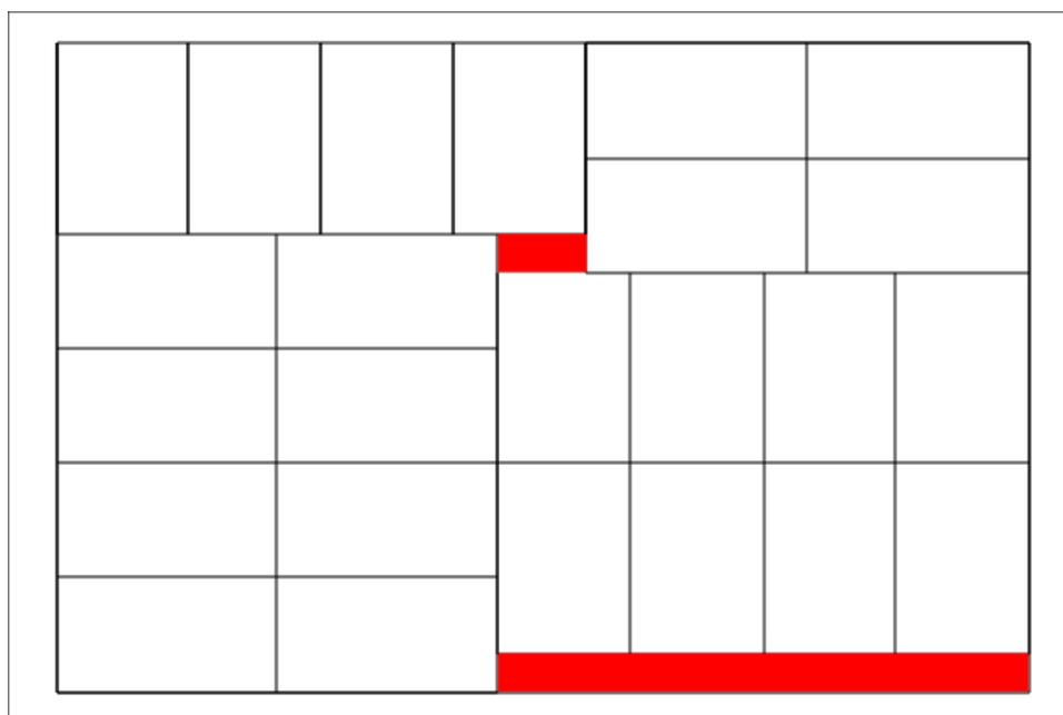
Si on veut utiliser un massicot : on obtient 23 morceaux pour le carton de 22 cm sur 17 cm avec une perte de  $29 \text{ cm}^2$ .
