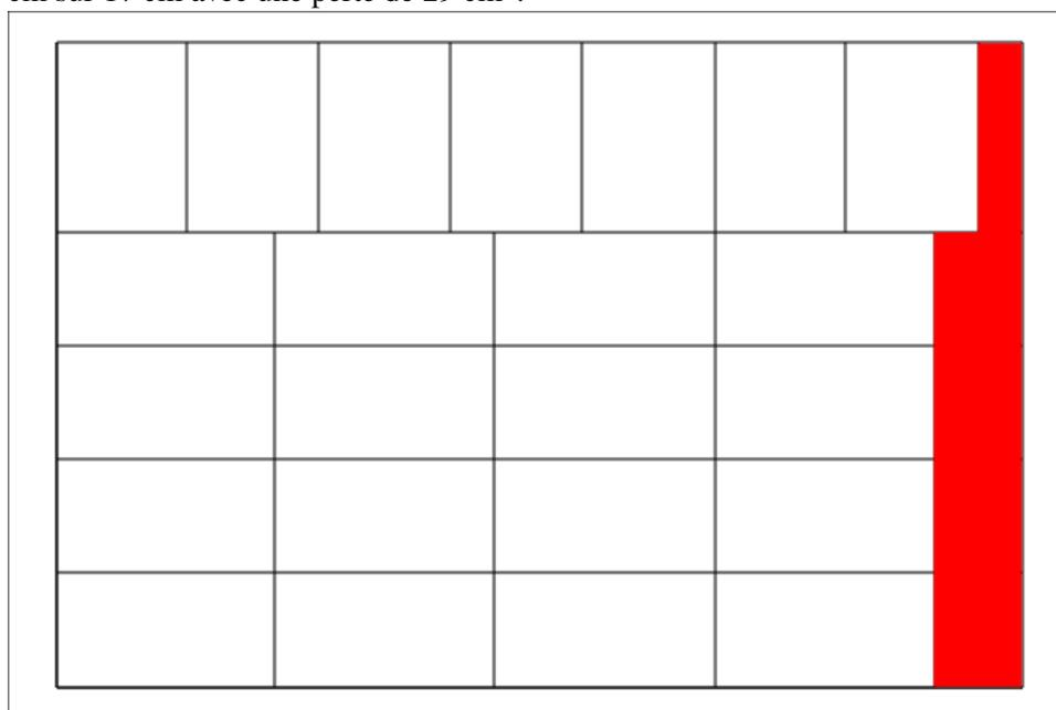
ce découpage est encore valable pour le carton de 22 cm sur 11 cm : en enlevant le rectangle du bas de largeur 6 cm. on obtient alors 15 morceaux avec une perte de  $17 \text{ cm}^2$ .
